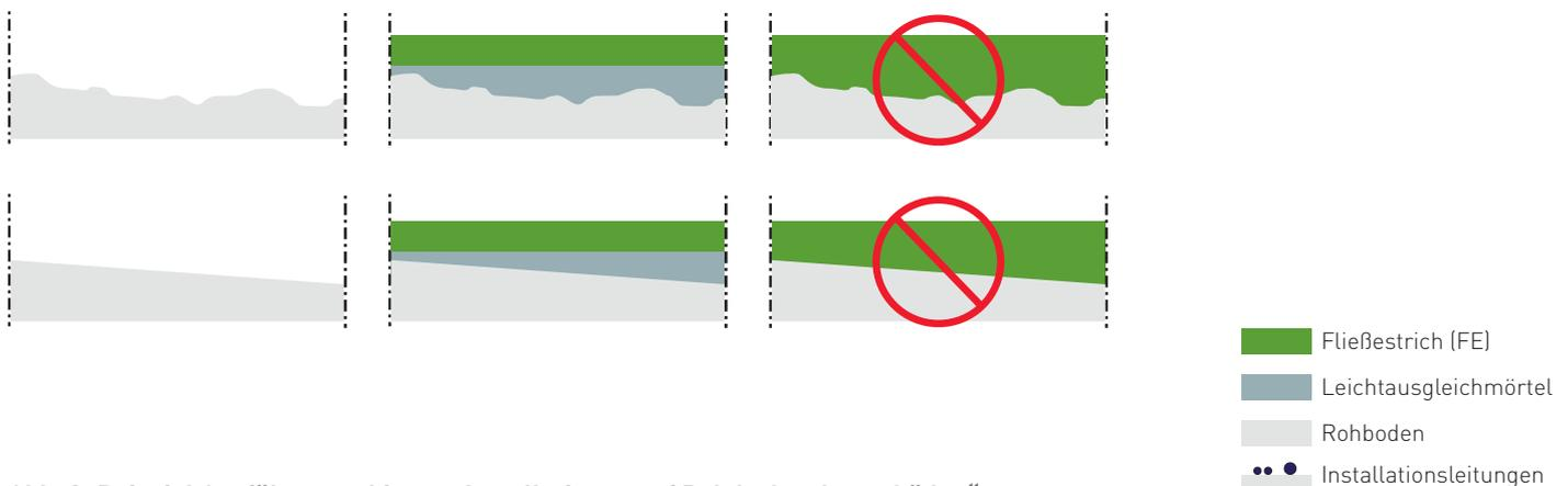
**Abb. 3: Beispiel Ausführungsskizzen** „Installationen auf Rohdecken bzw. -böden“
