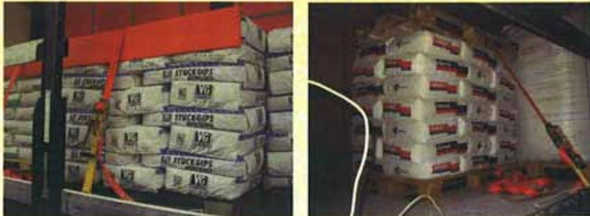
Alternative Sicherung einer Ladeinheit durch eine oben aufgesetzte Palette.
