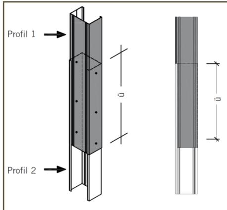
Variante 2: 2 CW-Profile stumpf gestoßen, mit CW-Profil geschachtelt und verschraubt
