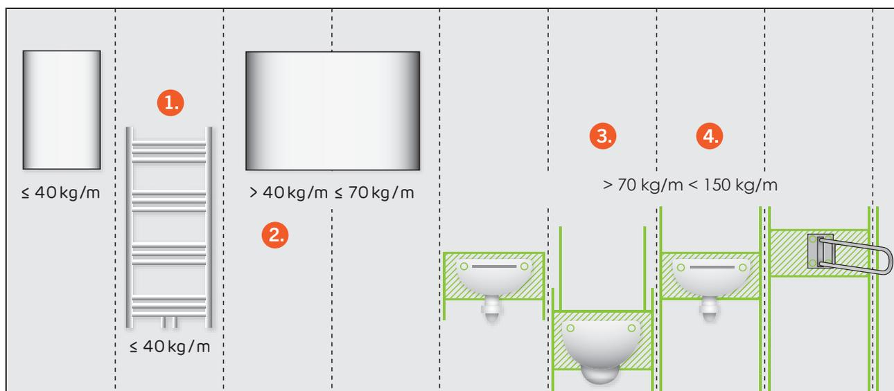
Abb. 1 Lastbefestigung an Trockenbauwänden, schematische Darstellung in Anlehnung an DIN 18183-1
