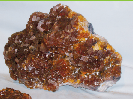
Abb. 12: Flussspat als Ausgangsstoff für Synthetischen Anhydrit
