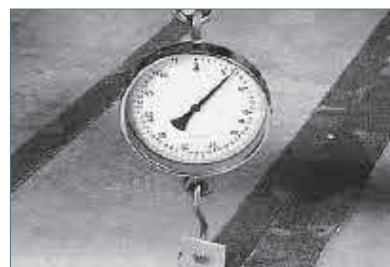
Probeverklebung und Prüfung des Schälwiderstandes
