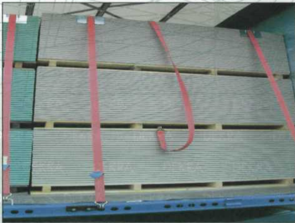
Gipskartonplatten 3lagig übereinander
