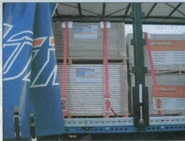
2lagig übereinander und 2fach gesichert
