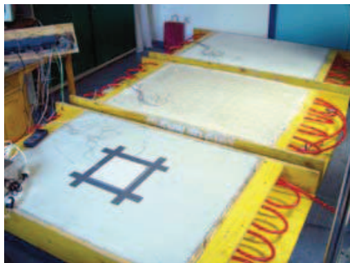
Bild 1: Messtechnischer Versuchsstand, Heizestrich Probekörper mit Messleitungen und Wärmestrom-Messfolie, TU-Wien [2].
