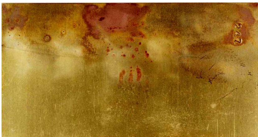
Farbabb. 33: Entzinkung an zinkreichem Messing CuZn39Pb2 nach Entfernung des Stuckgipses REA-Braunkohle, Auslagerung 3 Monate bei 100% relativer Luftfeuchte mit Vortrocknung
