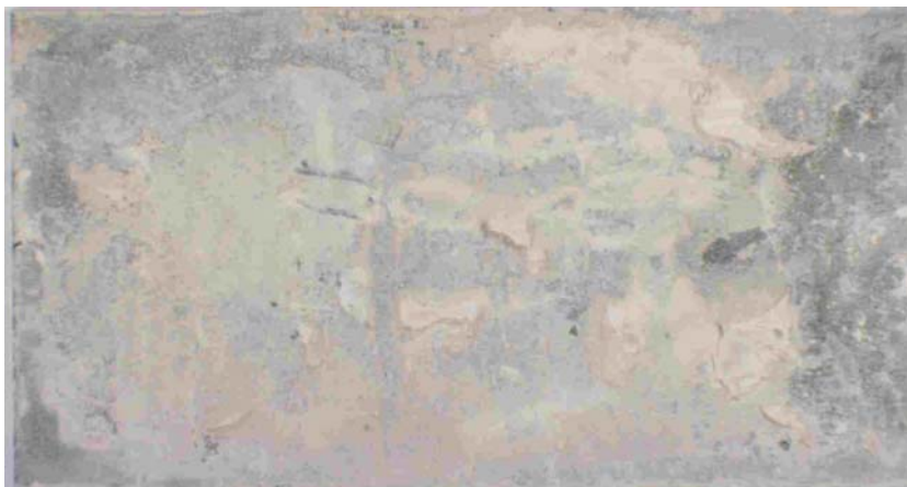
Farbabb. 21: Sendzimirverzinkte Stahlbleche nach Entfernung des Gipses, Auslagerung 24 Monate in bewittertem Außenklima (oben: in Stuckgips Naturgips; unten: in Stuckgips REA-Braunkohle)
