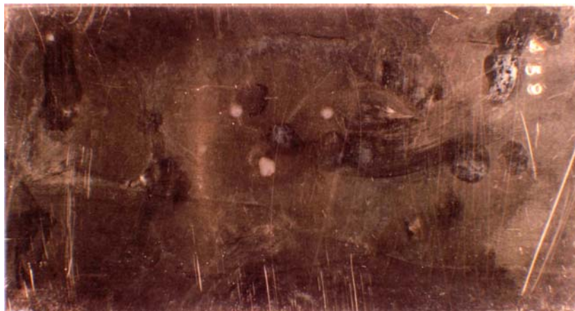
Farbabb. 28: Kupferbleche nach Entfernung des Gipses, Auslagerung 24 Monate bei 95% relativer Luftfeuchte (oben: in Stuckgips Naturgips; unten: in Stuckgips REA-Braunkohle)
