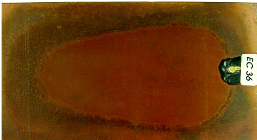
Farbabb. 43: Zinkreiches Messing CuZn39Pb2 nach elektrochemischen Untersuchungen und Entfernung des Gipses (alkalisierter Stuckgips REA-Braunkohle)
