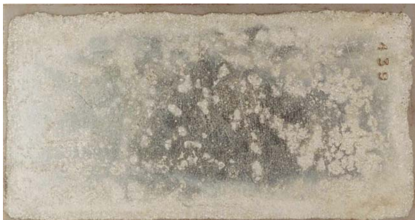
Farbabb. 17: Sendzimirverzinkter Stahl nach Entfernung des Stuckgipses REA-Braunkohle, Auslagerung 3 Monate bei 95% relativer Luftfeuchte (oben: nach Entnahme; Mitte: Kantenfläche; unten: Korrosionsprodukte abgebeizt)
