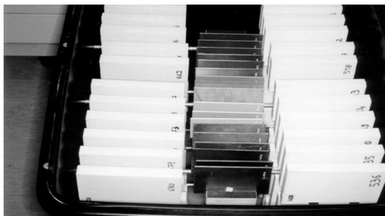
Abbildung 10.3: Auslagerung der Probekörper in Klimakammern über gesättigter NaCl-Lösung (konst. 75% rel. Feuchte) bzw. über gesättigter KCl-Lösung (konst. 95% rel. Feuchte) bei 20° C
