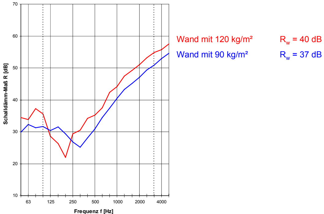
Abbildung 8.2 Einfluss der Gips-Wandbauplatten-Rohdichte auf die Schalldämmung, Plattendicke 100 mm, umlaufend 5 mm dicke Korkstreifen
