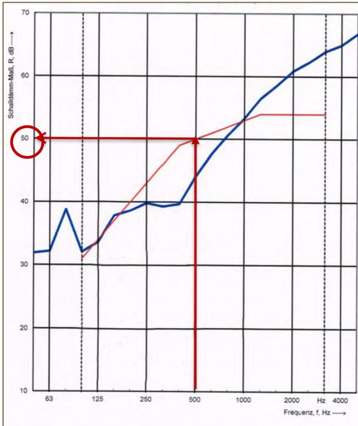
In das Diagramm mit der Kurve der ermittelten R-Werte (blau) wird die Bezugscurve nach ISO 717-1 (rot) gelegt.
