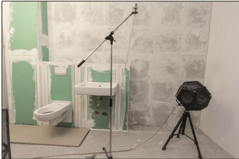
Der Nachweis des Luftschallschutzes erfolgt wie im Massivbau.
