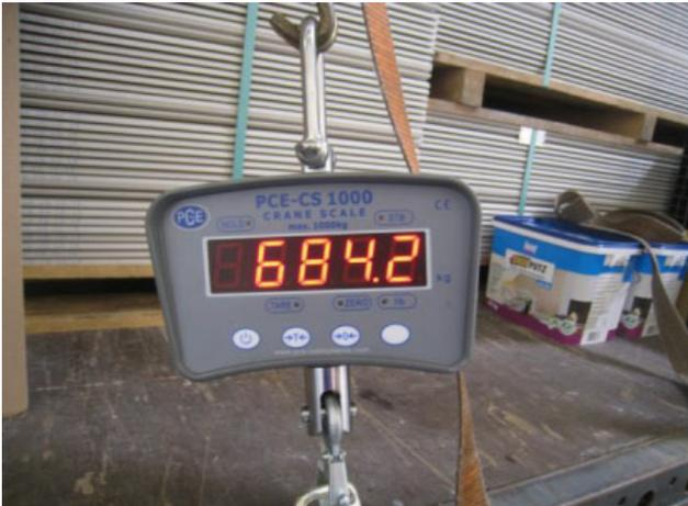
**Bild 3:** Vorspannkraft am Festende des Gurtsystems gemessen
