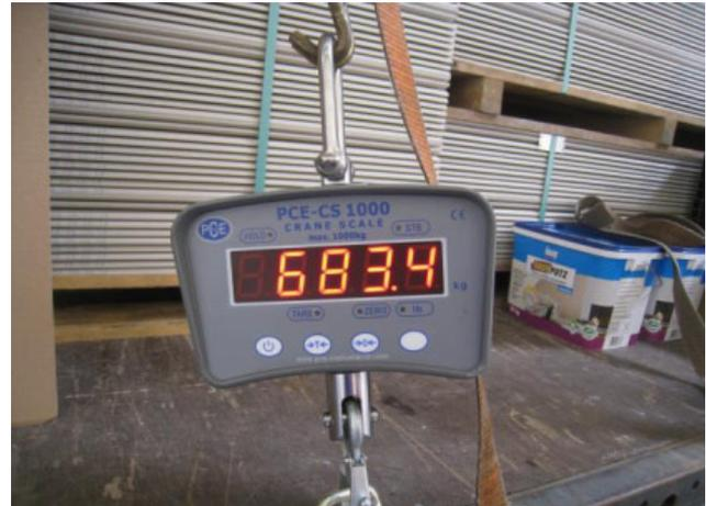
**Bild 4:** Vorspannkraft am Losende des Gurtsystems gemessen
